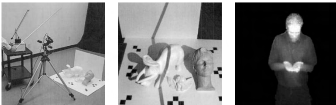
Слика 1.7: Скенирање облика помоћу бацања сенки: (а) подешавање камере са тачкастим извором светлости (стона лампа без рефлектора) и штап који се држи у руци и баца сенку; (б) објекти који се скенирају испред две планарне позадине и (с) мапа дубине у реалном времену добијена коришћењем система пулсирајућег осветљења.
