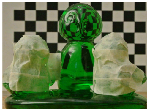
Слика 1.9: Снимање облика стакленог предмета посматрањем деформације статичног шаблона који је постављен у његовој позадини
