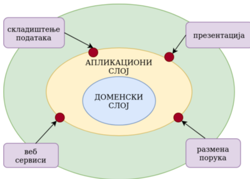
Слика 2.4: Слојевита архитектура апликације са инверзијом зависности
