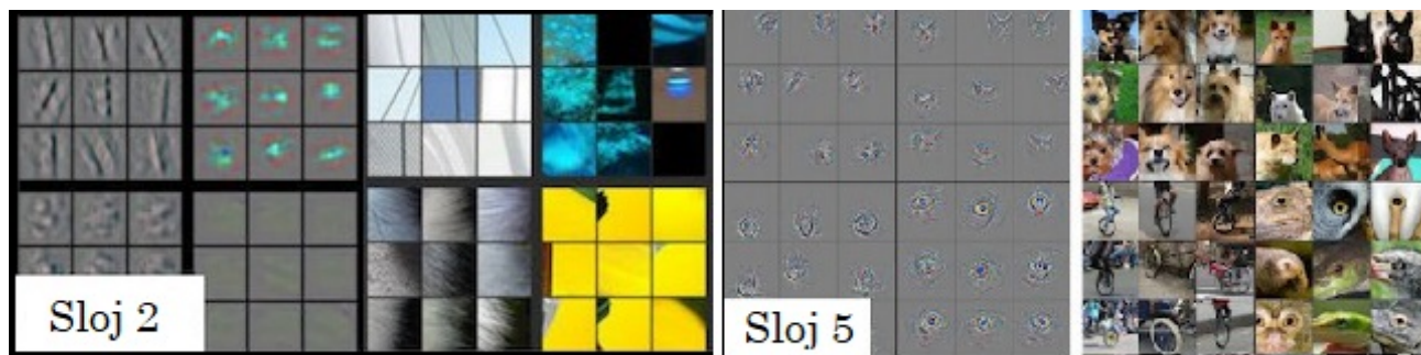
Slika 4.4: Filteri za prepoznavanje jednostavnih ( levo ) i kompleksnih oblika ( desno )[34].
