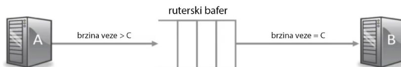
Slika 14: Primer jednog toka kroz jedan ruter i njegov bafer
