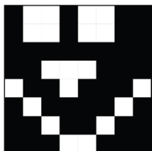
Слика 4. Заменом битова добија се инверзна слика
