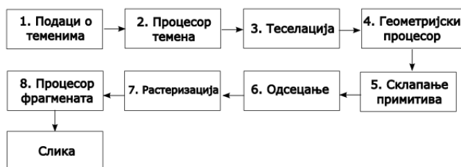
Слика 1: Процес креирања слике кроз OpenGL
