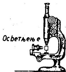
Сл. 105. Схема ултра-микроскопа
