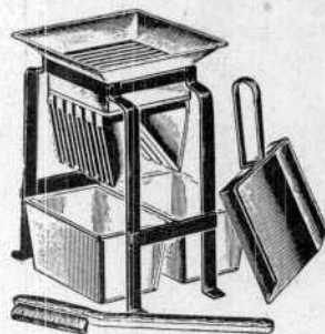
Sl. 3. — Aparat za polovljenje uzorka.
