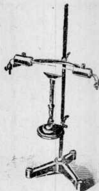
Sl. 103. — Upotreba Drehschmidt-ove platinske kapilare.
