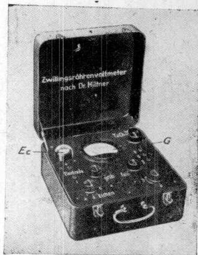
Sl. 65. — Cijevni voltmetar po Hiltner-u. Ec elektronska cijev; G galvanometar.
