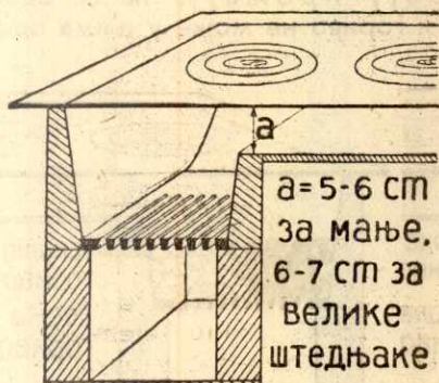
Висина димног канала између ватреног моста и плоче је врло значајна за исправан рад штедњака
