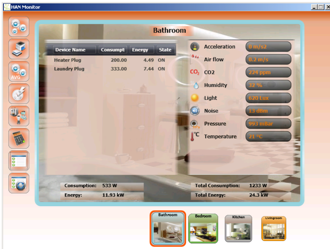
Korisnički interfejs za pregled vrednosti pročitanih sa senzora i pregled potrošnje električne energije za izabranu prostoriju
